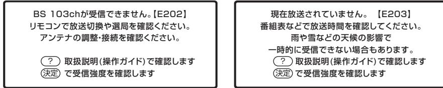
このような画面が表示されているときに「決定」を押すと、選局しているチャンネルの受信強度が表示されます。受信状態に応じた対処が必要です。(画面は一例です。)
