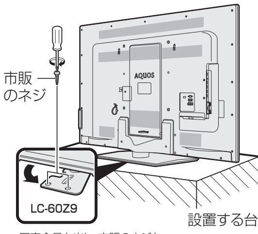
固定金具を出し、市販のネジを使って取り付けます。
