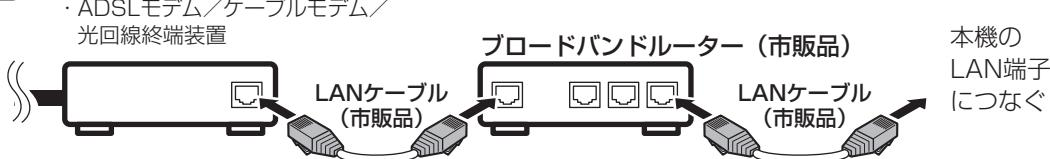
接続例 ルーター機能付き ADSL モデム／ケーブルモデム／光回線終端装置などに、
